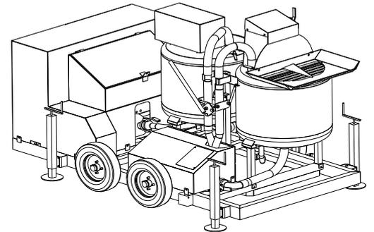
Coulis avec doses de ciment de 105 à 210 Kg (de 3 à 6 sacs de 35 kg). Les coulis sont préparés avec un double système batteur avec disque agitateur grande vitesse et turbo de recirculation.
